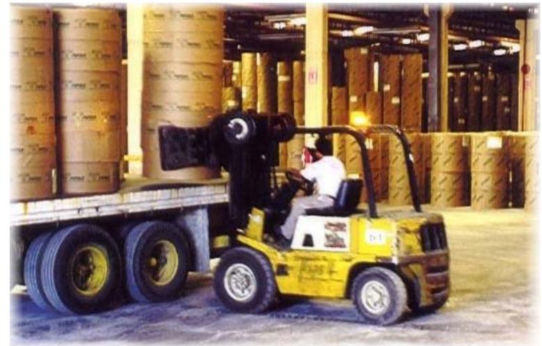
**Máquinas autopropulsadas que se desplazan sobre el suelo y están destinadas a llevar, empujar, tirar o levantar cargas colocadas, generalmente sobre una tarima de carga, que posee dos aberturas en las cuales se introducen los brazos de las horquillas del montacargas**
