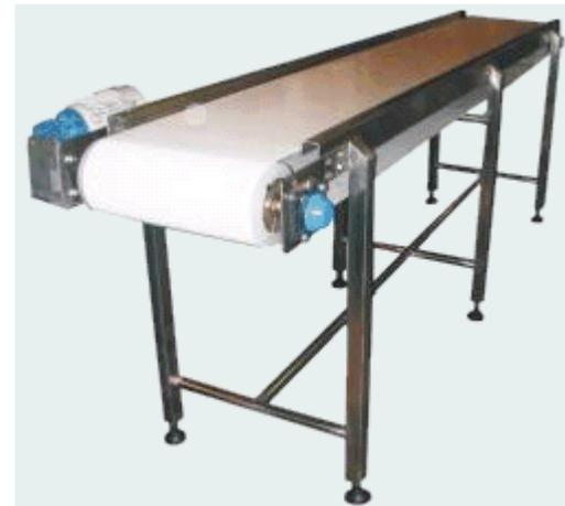
**Dispositivo horizontal, inclinado o vertical, que sirve para mover material a granel, cajas u objetos sobre una banda, de acuerdo a una trayectoria predeterminada, con puntos de carga y descarga fijos.**
