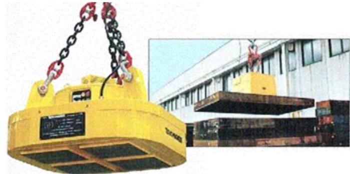
**Dispositivo electromagnético montado en una grúa, que consta de una bobina de hilo conductor enrollada alrededor de un núcleo de hierro dulce. Al hacer pasar una corriente eléctrica por el hilo genera un campo magnético y el núcleo queda magnetizado. Sirve para manejar materiales ferrosos.**
