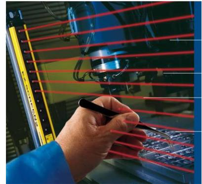
5. **Dispositivo sensitivo.** Está constituido por una cortina luminosa (celda fotoeléctrica). La interrupción de esta cortina luminosa provoca la emisión de una señal que para la máquina.
