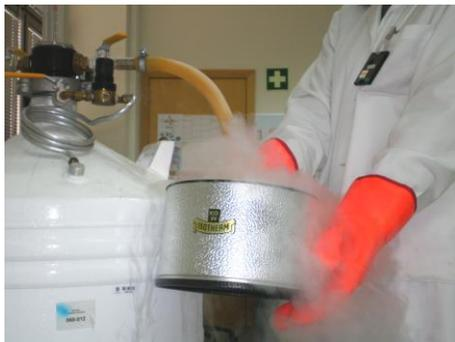
a) **Gases inertes:** Estos no tienen una reacción química significativa. No se queman ni permiten la combustión. Ejemplos de este grupo incluyen el nitrógeno, helio, neón, argón y criptón.
