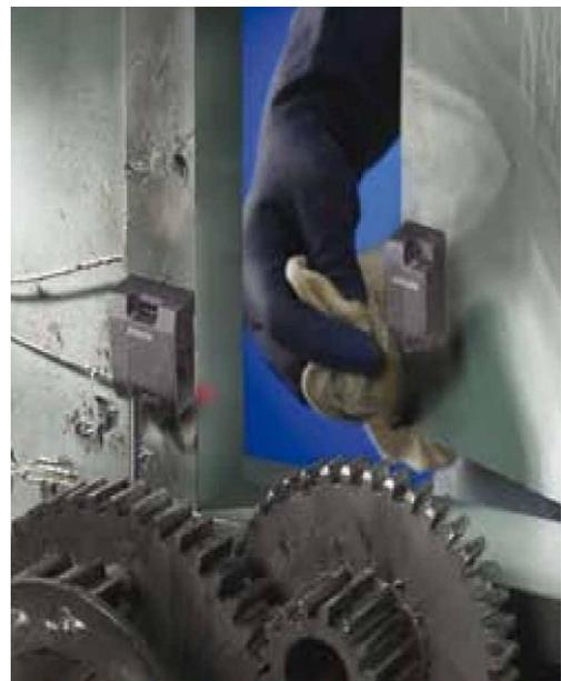
3. **Dispositivo de retención mecánica.** En ocasiones es necesario y conveniente reforzar el dispositivo bloqueador asociado a un protector mediante otro dispositivo de retención mecánica, de tal manera que la máquina mantenga su posición cerrada durante la operación.
