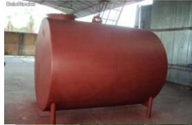
e) Recipientes que trabajen interconectados en una misma línea de proceso, donde la presión de operación del conjunto de equipos y de cada uno de los equipos, se encuentren entre 29.42 kPa y 196.14 kPa de presión manométrica y, al final de la línea de proceso, se encuentren abiertos a la atmósfera
