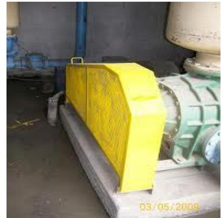
2. **Protector semifijo.** El uso de estos protectores está determinado por el tipo de operaciones que se realizan en la máquina; en caso de requerirse, pueden ser retirados en forma manual por el trabajador, para lo cual deben preverse las facilidades de montaje y desmontaje del caso.
