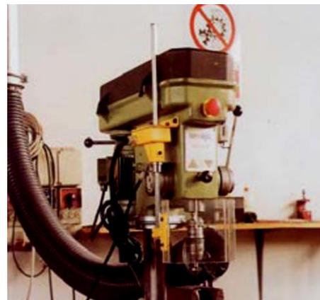
3. **Protector móvil.** Elemento que cubre mecánicamente a la estructura de una máquina o a un elemento vecino fijo; dicho enlace se realiza generalmente mediante una articulación o sobre guías de deslizamiento.
