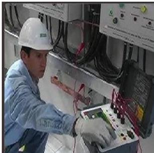
Para medir la **resistencia**, verifica que se haya empleado un **medidor de resistencia de red de puesta a tierra**.
