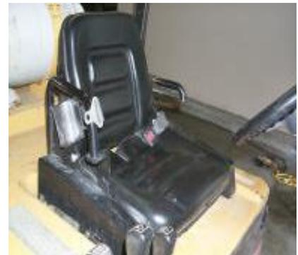
La mayoría de los fabricantes de estos vehículos recomiendan el uso de cinturón de seguridad para el operador e instalan sistemas de sujetadores en los vehículos nuevos donde se puedan sentar. Desde 1992, a los fabricantes de montacargas se les ha exigido que equipen los montacargas nuevos con cinturones de seguridad.
