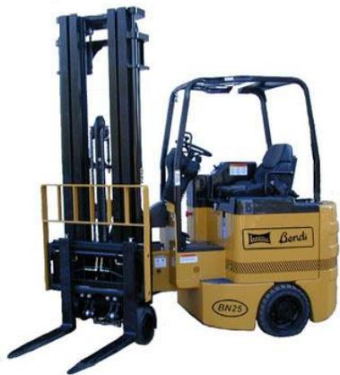
Esta es otro montacargas con la diferencia que en ésta tenemos un mástil que se desplaza hacia las laterales pero con cierto ángulo de inclinación para que las horquillas recojan elementos es esquinas o que son difíciles de coger con la otras montacargas.
